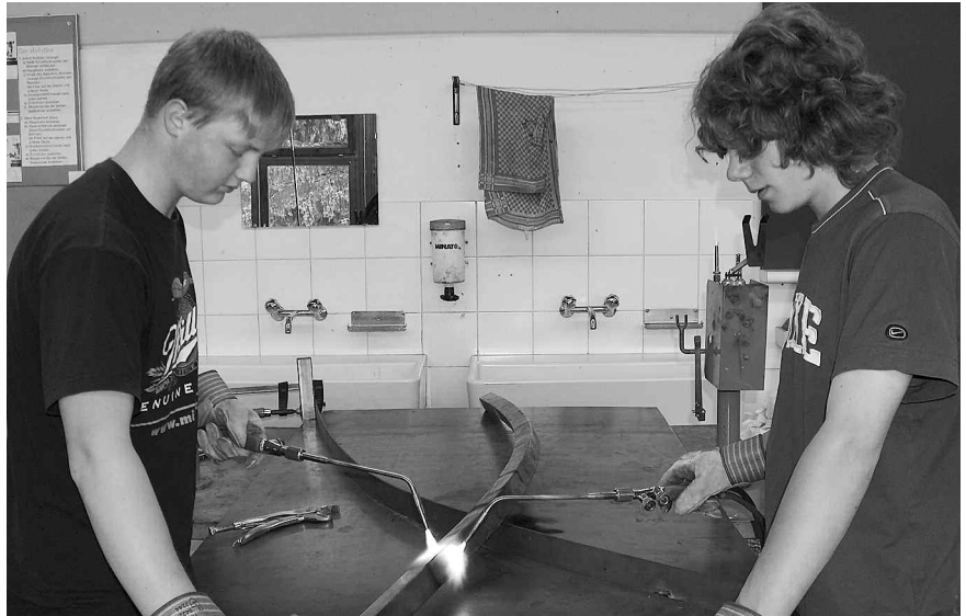
Links Mischa Virjevitc und rechts Ivan Zumbühl beim Biegen mit viel Wärme
