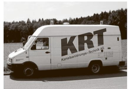
Kommandofahrzeug für Kanalfernsehaufnahmen
