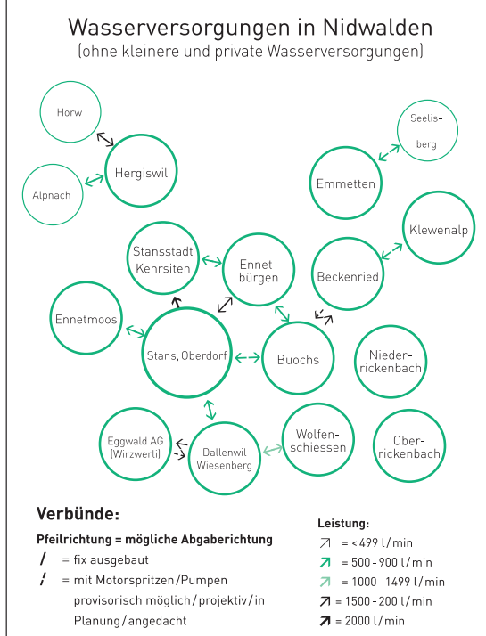
Verbindungen der Wasserversorgungen im Kanton Nidwalden
