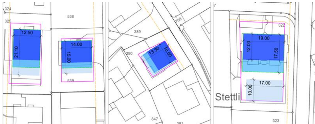
Abbildung 7 Beispiel Überprüfung ÜZ und Grenzabstand
